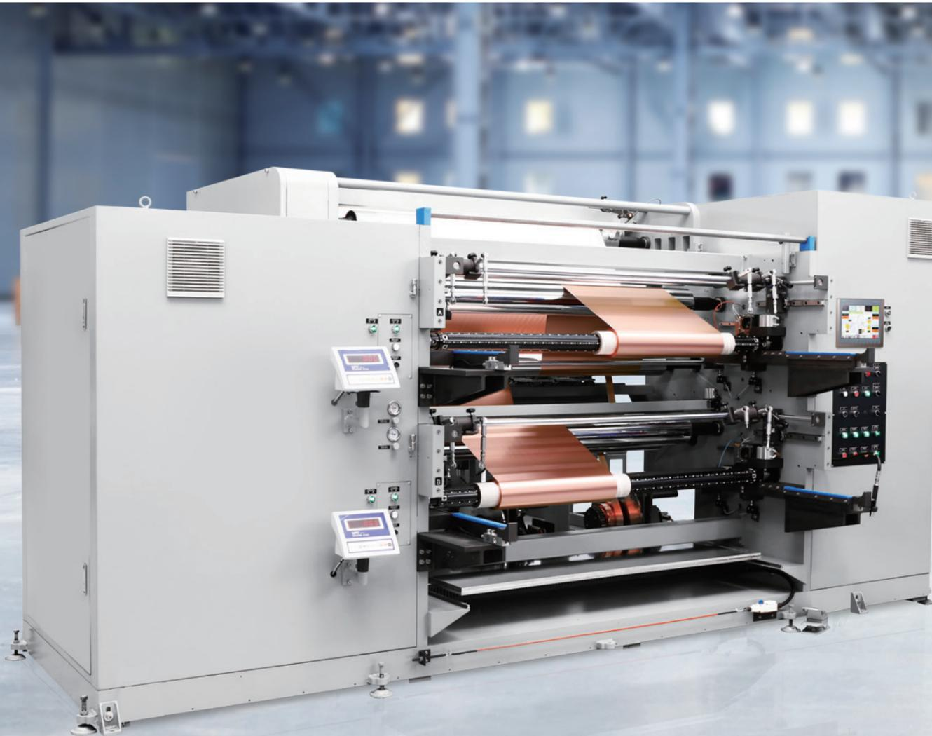
已研發各種適用於高科技產業用銅箔分條機，產品規格齊全，用途涵蓋各式玻璃纖維環氧樹脂基材、多層印刷電路板、軟性電路板、IC載板、鋰離子電池、紙-酚醛樹脂基板等。
